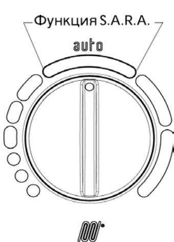
Данная функция позволяет автоматически выбирать температуру теплоносителя в зависимости от меняющейся тепловой нагрузки. Функция активируется только при наличии комнатного термостата. Включение и отключение данной функции сопровождается частым миганием светового индикатора зеленого цвета.
